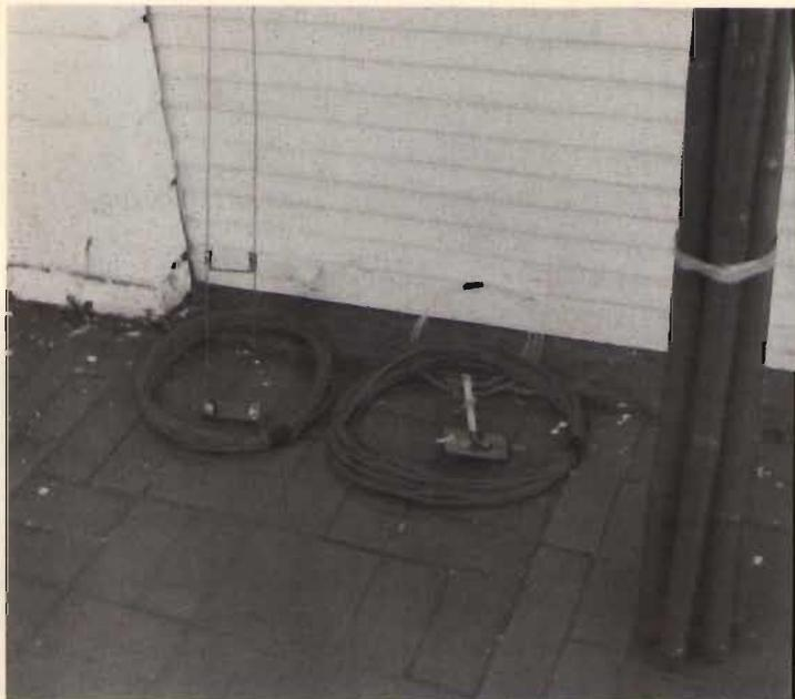
*In primo piano il "fascio" di canne di bambù già pitturate a smalto. Segue il cavo dell'elemento pilota e relativo SO239 sulla sua basetta in PVC. Cavo dell'elemento riflettore e relativa sezione di accordo (in rame rigido).*
