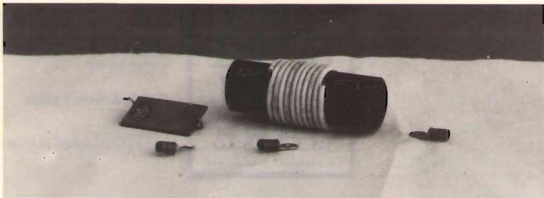
Se risultasse necessario, si può variare la frequenza della trappola asportando con un coltellino un po' di rame sulla piastrina di circuito stampato fino ad avere le seguenti frequenze di risonanza: 24,950 MHz (trappola dei 12 metri), 18,120 MHz (trappola dei 17 metri), naturalmente con  $\pm 20$  kHz di tolleranza.
