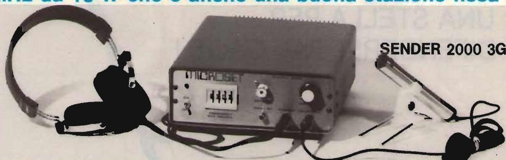
Il Sender 2000/3G è un apparato prestigioso, sofisticato, sicuro e versatile, funziona da stazione portatile con alimentazione a  $13 \pm 15$  Vcc.
