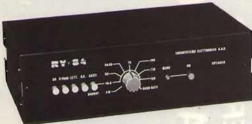
Gestito a microprocessore, decodifica un segnale tipo TTY (codici ASCII e BAUDOT) o CW. Può essere collegato a monitor video, comune televisore e stampante. Consente la ricezione di emissioni da parte di radioamatori, agenzie di stampa, stazioni meteorologiche ecc.
